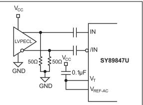
FIGURE 6-2: LVPECL Interface (AC-Coupled).
